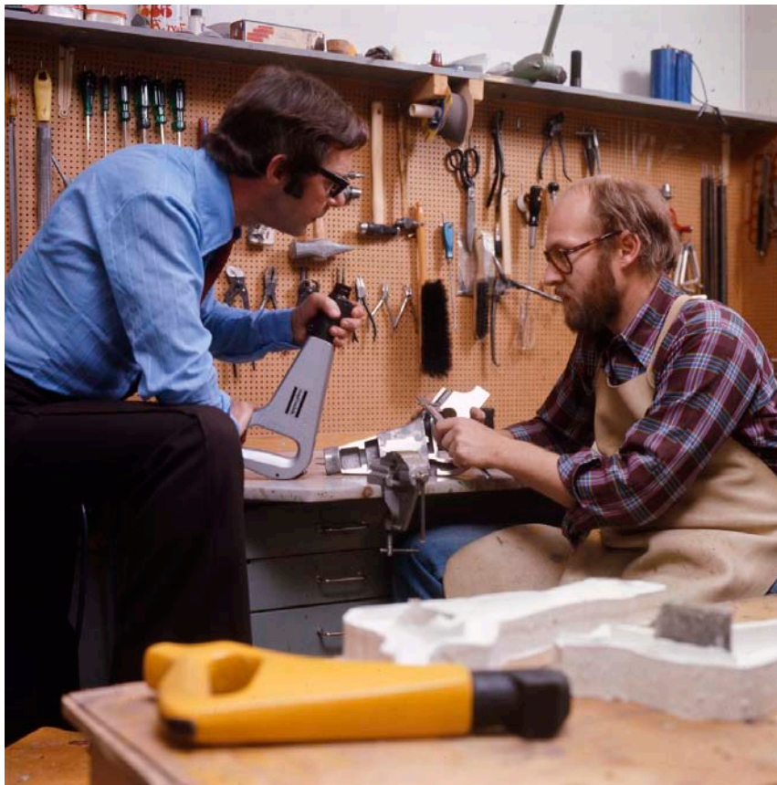
Atlas Copcos avdelning för formgivning, Sickla i Nacka 1976. Industridesigner Rune Zernell diskuterar utformningen av en luftdriven mejselhammare med en kollega.
